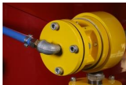
Bloc décompression & pression Arrêt immédiat air
